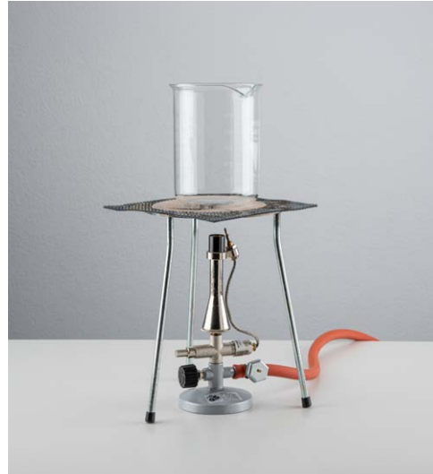
Abbildung 3 Bunsenbrenner mit Dreibein, feuertfestem Keramiknetz und Becherglas darauf
